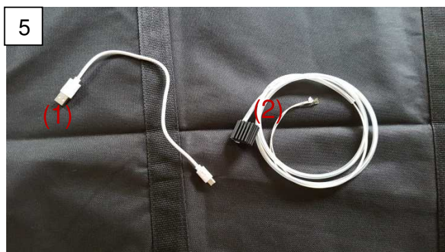
5. Connecter le convertisseur (1) à la powerbank ou à un ordinateur
